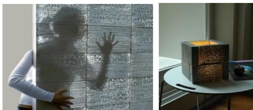
شكل 3 الخرسانة الشفافة أو التي تسمح بمرور الضوء Concrete passing of light
